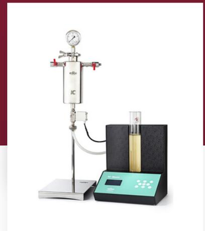
Requiere substituir el grifo de salida del equipo IC por la electroválvula que incorpora el equipo, y de este modo automatizar al 100% el procedimiento.
