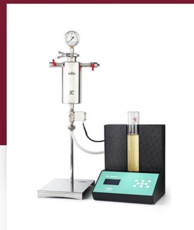
Este equipo de índice de colmatación es una herramienta insustituible cuando el vino se ha de pasar por un filtro de membrana para alcanzar su estabilización biológica y conseguir así una medida objetiva del grado de filtrabilidad de un vino.
