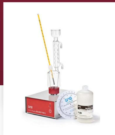
La temperatura de ebullición de los vinos secos es símbolo de su riqueza alcohólica, de la altitud, y de la presión atmosférica. Se apuntan las temperaturas de ebullición del agua y del vino que analizar, y se reportan a un disco de cálculo que da directamente el grado alcohólico volumétrico con una precisión de 0,1 % Vol.
