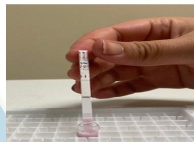
Coloque la tira con las flechas hacia abajo e incube a temperatura ambiente: El líquido sube a la línea de control (línea más alta) en 1-2 minutos
