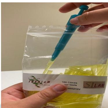
Coloque la punta en el extremo de la pipeta SIN tocar la punta con los dedos.
